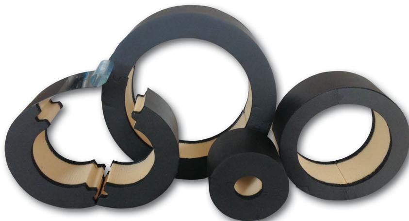
**ISOCLAMPS** se utilizan para eliminar las lagunas de aislamiento y reducir la posibilidad de puente térmico, durante el soporte del tubo aislado hecho por collar o soporte de metal, en refrigeración o calefacción. Se sugieren para aplicaciones donde la temperatura está entre -45°C a +105°C.
